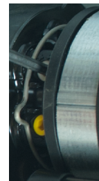
"DOWN" Limit (I) "AB" Grenze (I) Vis de réglage de limite inférieure (I)
